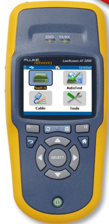
**TruePower™ PoE-Tests:** Schnelles Prüfen der PoE-Leistung durch Strombezug bis zu 802.3at (25,5 W). Leistungsmäßige Belastungstests von Switches, Verkabelung und Patchpanels, während gleichzeitig die anliegende Spannung und die verwendeten Paare gemessen werden. Die Möglichkeit, die TruePower-Bereitstellung vor der Installation von Kameras, APs und Telefonen zu prüfen, ermöglicht eine reibungslose Implementierung.
